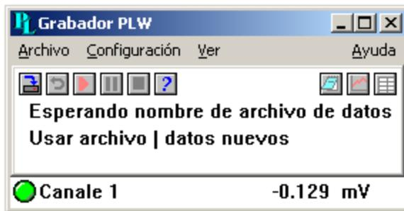
12. Conecte una tensión apropiada (por ejemplo, de una batería de 1,5 V) al canal. Las conexiones de los terminales están marcadas en el registrador y también se indican en el tema [Conector analógico](#).
