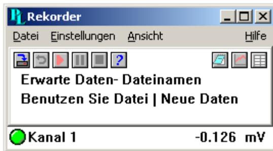
12. Schalten Sie eine geeignete Spannung (z. B. von einer 1,5-V-Batterie) an den Kanal. Die Stiftanschlüsse sind am Datenlogger markiert und ebenfalls unter [Analoganschluss](#) aufgeführt.
