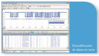
Los osciloscopios PicoScope Serie 6000 son especialmente apropiados para la decodificación en serie, con un búfer de memoria profunda que les permite recoger secuencias largas e ininterrumpidas de datos. Esto permite la captura de miles de estructuras o paquetes de datos durante varios segundos. Los osciloscopios pueden decodificar hasta cuatro buses a la vez con la selección de protocolo independiente para cada canal de entrada.
