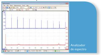
Con un clic, podrá abrir una nueva ventana para ver una curva de espectro de los canales seleccionados. El analizador de espectro permite visualizar señales de hasta 500 MHz (dependiendo del modelo de osciloscopio) en el dominio frecuencial. Una gama completa de ajustes le permite controlar el número de bandas de espectro, los tipos de ventanas y los modos de visualización.
