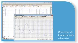
Genere formas de onda estándar de CC de hasta 20 MHz (todos los modelos) o defina las suyas propias utilizando la potencia del generador de formas de onda arbitrarias de 12 bits y 200 MS/s (solo modelos B). Puede importar formas de onda arbitrarias desde archivos de datos o dibujarlas utilizando el editor AWG integrado.
