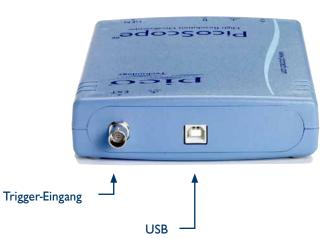
An der Rückwand des PicoScope 4262 befinden sich zwei Anschlüsse: ein USB-Anschluss zur Verbindung mit einem PC und eine BNC-Buchse zum Anschließen eines externen Triggers.
