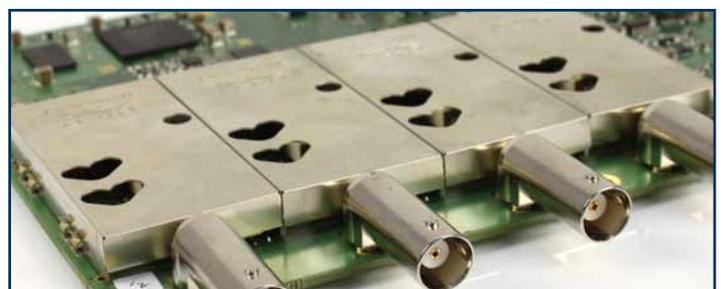
Die ausgereifte Front-End-Konstruktion und Schirmung reduzieren das Rauschen, Kreuzkopplungen und den Klirrfaktor. Auf der Grundlage unserer langjährigen Erfahrung in der Entwicklung und Herstellung von Oszilloskopen bieten wir Ihnen Geräte mit verbessertem Frequenzgang und optimierter Bandbreitenflachheit.
