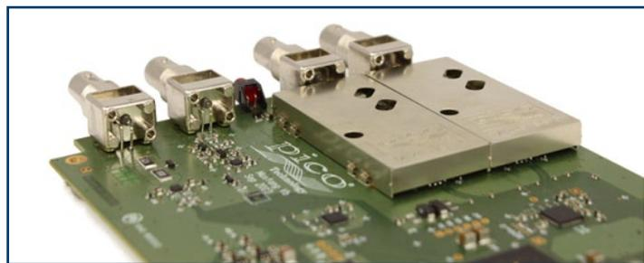
El cuidadoso diseño y la protección de la parte frontal reducen el ruido, las interferencias cruzadas y la distorsión armónica. Años de experiencia en la fabricación de osciloscopios han dado como resultado una mejora en la respuesta de impulso y la planeidad del ancho de banda.
