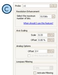
Las opciones de canal permiten acceder a ajustes específicos de los canales, como sondas personalizadas, mejora de la resolución, controles de desviación y filtrado.
