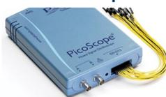
Si bien presentan un formato de 2 + 16 canales, los MSO PicoScope serie 3000 siguen siendo osciloscopios provistos de todas las prestaciones. Incorpora un generador de formas de onda arbitrarias e incluye una función de barrido.
