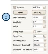
Generador de funciones: permite al osciloscopio generar señales estándar o formas de onda arbitrarias. Incluye opciones de barrido de frecuencia.
