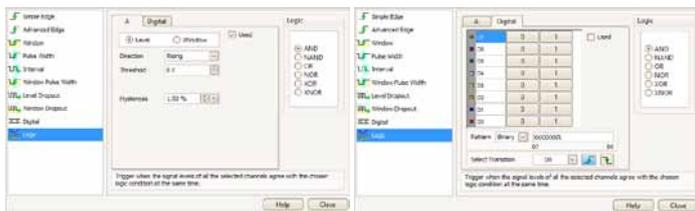
El disparo digital reduce el retraso del rearme y, combinado con la memoria segmentada, posibilita la activación y la captura de eventos que tienen lugar en una secuencia rápida. Nuestra función de prueba de límites de máscaras puede, posteriormente, analizar estas formas de onda y resaltar formas fallidas para visualizarlas en el búfer de formas de onda.
