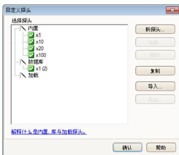
自定义探棒功能可使您校正专用探棒中的增益、衰减、偏移与非线性，或者转换为不同测量单位（如电流、功率或温度）。您可以将定义保存至磁盘以供日后使用。内置有关于 Pico 所提供标准示波器探棒和电流钳的定义。
