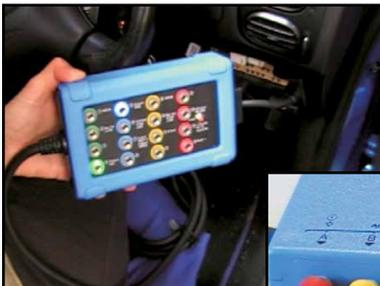
CTB ist an DLC-Anschluss des Fahrzeugs angeschlossen
