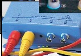
Oszilloskop-Anschluss der CTB-Messfühlerleitung (BNC)
