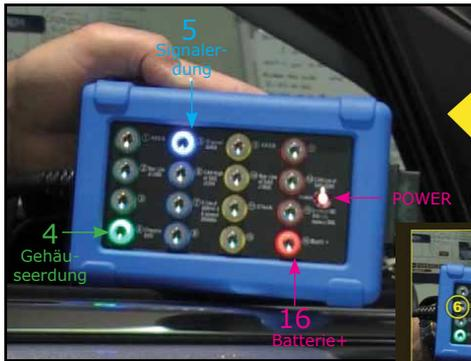
Die Abbildung zeigt die CTB-LEDs STROM, 4 (grün), 5 (blau), 16 (rot) "eingeschaltet", was bedeutet, dass das Gerät an eine Stromquelle angeschlossen ist und die Erdungsleitungen betriebsbereit sind.
