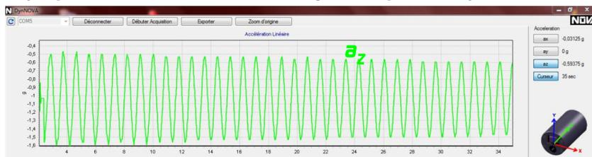
On peut alimenter le moteur par une rampe de tension qui va augmenter progressivement la vitesse de rotation du disque et donc permettre un balayage des fréquences d'oscillations du ressort. On peut ainsi étudier les régimes transitoires et la résonance.
