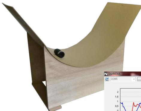
Le capteur **DynNOVA** peut rouler sur lui-même. Il suffit de le lâcher sur un des bords de la rampe. Grâce au gyromètre, on suit l'évolution de sa vitesse d'oscillation. Grâce à l'accéléromètre, on observe les variations de vitesse subies. En associant les 2 données, on peut étudier le comportement complet du mouvement amorti en chaque instant.
