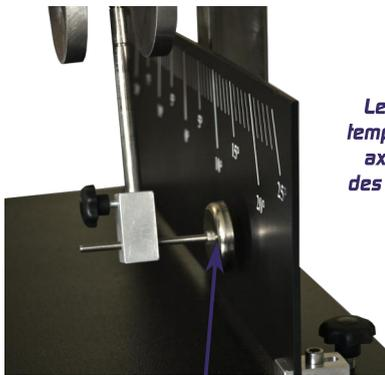
La force de freinage par courant de Foucault est réglable en ajustant la distance de l'aimant. La comparaison peut être faite facilement avec le système de freinage par friction également disponibles sur nos pendules.
