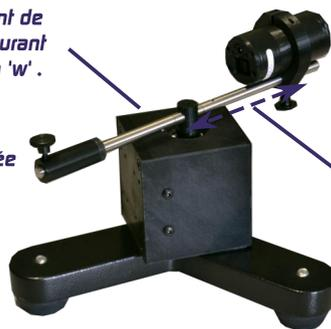
Le capteur DynNOVA est fixé sur l'une des extrémités de la tige. Sa masse M est connue.
