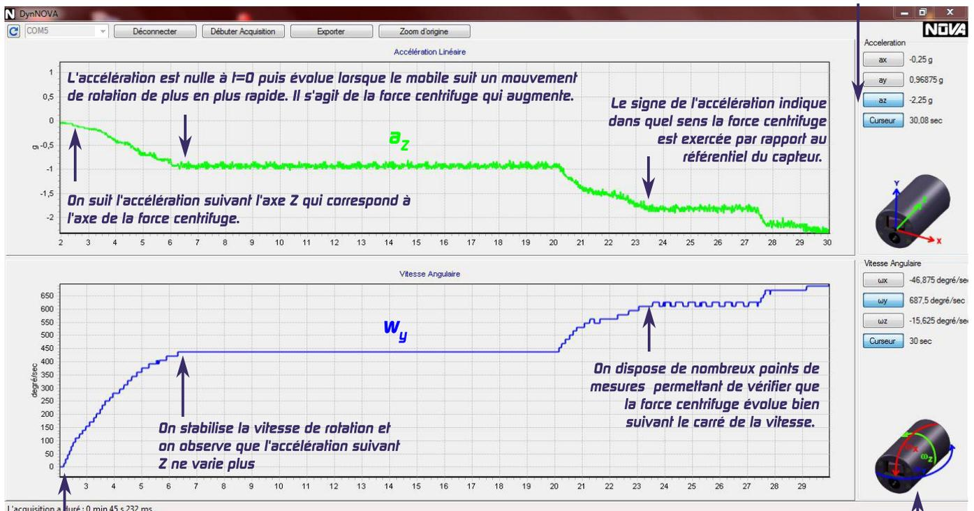
On augmente progressivement la tension d'alimentation et donc la vitesse angulaire de l'axe de rotation. On connaît précisément la vitesse réelle du mobile grâce à la donnée 'w<sub>y</sub>' du gyromètre.
