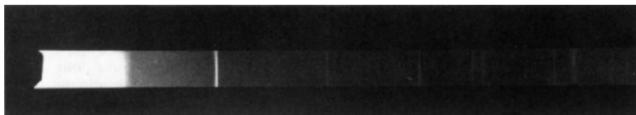
Figure 6 : Cliché de diffraction des rayons X de l'anatase
