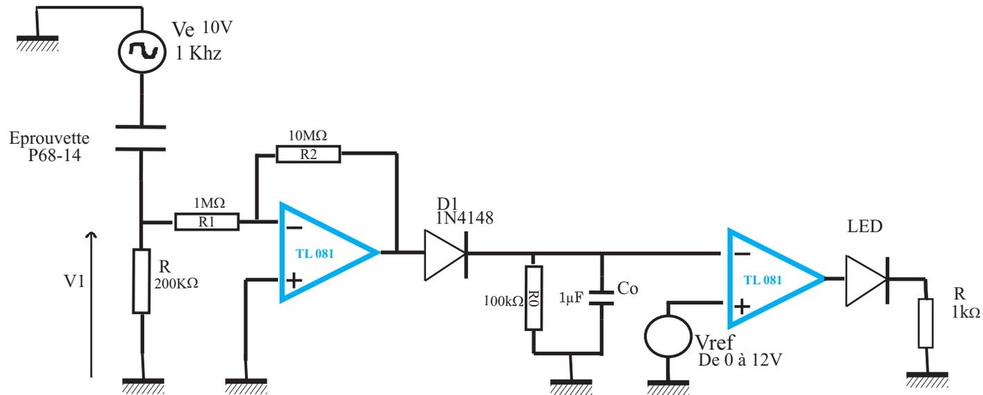
La Capacité de l'éprouvette varie entre 10pF (vide) à 120pF (pleine d'eau)
